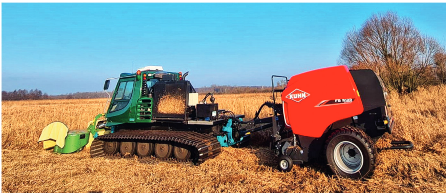
Abbildung 7-4 Raupenbasierte Zugmaschine (umgebauter PistenBully 200) und Rundballenpresse mit Breitreifen (Foto: S. Petri)
