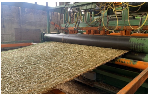
Abbildung 5-17 Die Herstellung von Erosionsschuttmatten bei der Angermünde Mattenbrigade (Foto: B. Spanjers)
