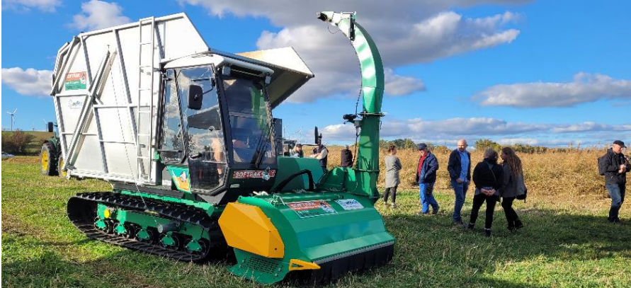
Abbildung 7-3 Multifunktionale, serienmäßige Raupen- und (einstufige) Erntetechnik (Softrak 120) der Firma Loglogic, Technikvorführung am 19. Oktober 2022 im Randowtal/Uckermark (Foto: C. Dammann).
