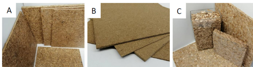
Abbildung 5-8 Plattenwerkstoffe aus Paludikulturen mit unterschiedlichen Aufbereitungsverfahren (A Heuplatten aus Seggen, Binsen, Schilf und Rohrglanzgras, B Faserwerkstoffplatten aus zerfasertem frischem Rohrglanzgras, Leichtbauplatte aus geschnittenen Typhastängeln (Abb. C. Lühr, ATB)
