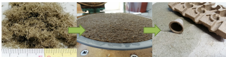
Abbildung 5-13 Moorbio­masse (Rohrglanzgras) in aufgefaserter Form zum Einsatz im Sektor Pulp & Paper zur Herstellung von Papieren und Faserformteilen (Faserguss) (Abb. C. Lühr, ATB)
