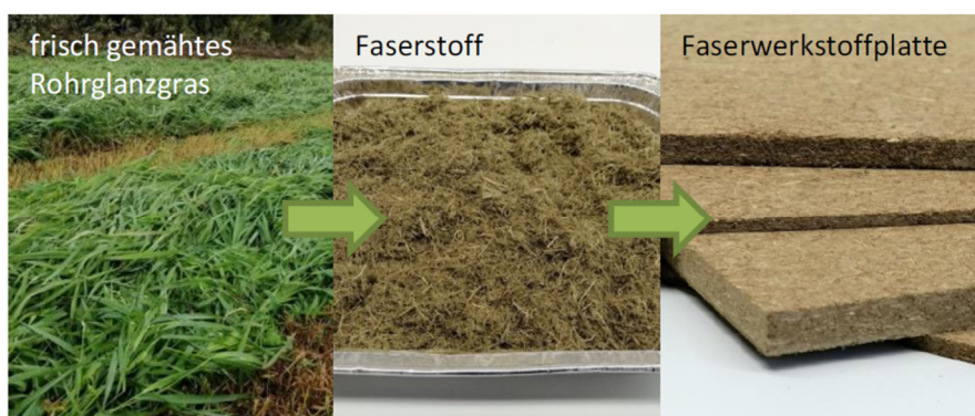
Abbildung 5-7 Grün geerntetes und frisch zu Faserstoff aufbereitetes Rohrglanzgras im Endprodukt einer Faserwerkstoffplatte (Abb. C. Lühr, in Spanjers 2021)
