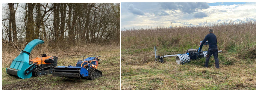
Abbildung 7-1(A) Funkgesteuerte Geräteträger mit vielen Anbaumöglichkeiten der Firma IRUS, Technikvorführung „Raupenshow“ am 30. März 2022 in Kremmen (Foto: B. Spanjers), Abbildung 7.1 (B) Handgeführte (auch funkgesteuert möglich) Technik der Firma Brielmaier, Technikvorführung am 6. Oktober 2021 in Schenkenberg (Foto: B. Spanjers)
