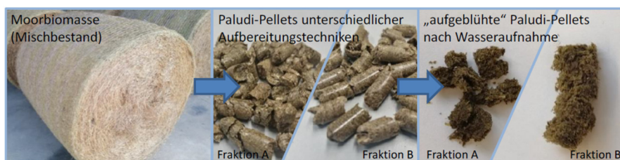
Abbildung 5-3 Moorbilomasse (Mischbestand) in weiterverarbeiteter Form als Pellet unterschiedlicher Partikelmorphologie (Fraktion A und B) sowie dem fraktionsabhängigem „Aufblühverhalten“ nach Feuchtigkeitsaufnahme im Labor (Pelletform der Fraktion B bleibt durch ihre faserige Struktur besser erhalten) (Abb. C. Lühr, in Spanjers 2021 )
