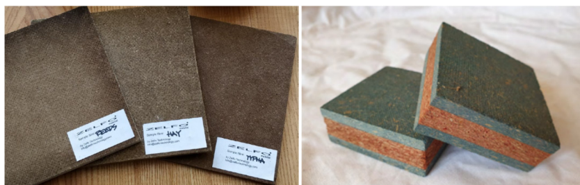
Abbildung 5-10 Faserverbundplatte aus Nasswiesen-Biomasse. Hergestellt von ZELFO Technology. (Foto: S. Manzel)
