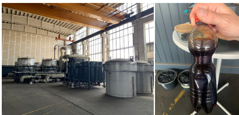
Abbildung 5-6 A. Pyrolyseanlage der Carbonauten in Eberswalde B. Neben den Pflanzenkohlen sind auch die gewonnenen Flüssigkeiten lukrative Produkte des Pyrolyse-Prozesses. (Fotos: B. Spanjers)
