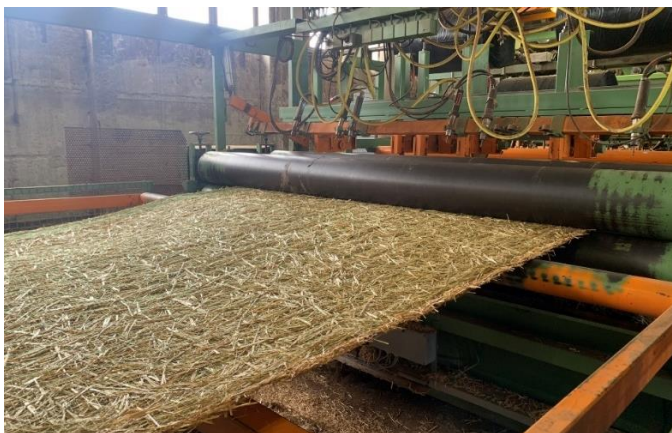
Abbildung 5-18 Die Herstellung von Erosionsschuttmatten bei der Angermünde Mattenbrigade (Foto: B. Spanjers)
