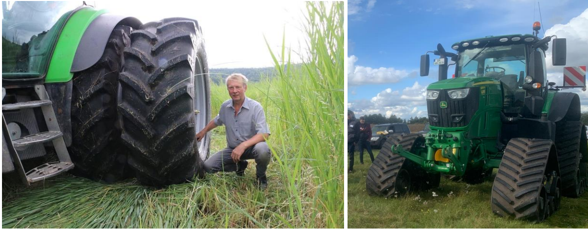
Abbildung 7-2 A. Landwirt Schreiber aus Boberow lässt Luft aus den Zwillingsschneidern, um einen geringeren Bodendruck zu erreichen (Foto: Martina Grade), Abbildung B. Schlepper mit Delta-Laufwerken, Technikvorführung am 6. Oktober 2021 in Schenkenberg (Foto: B. Spanjers)
