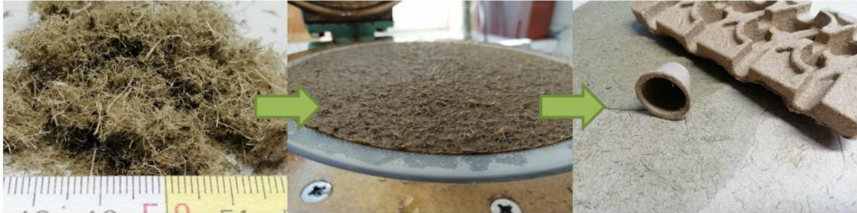
Abbildung 5-14 Moorbiomasse (Rohrglanzgras) in aufgefaserter Form zum Einsatz im Sektor Pulp & Paper zur Herstellung von Papieren und Faserformteilen (Faserguss) (Foto: C. Lühr, ATB)
