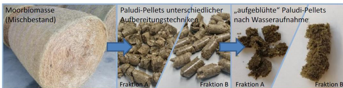
Abbildung 5-3 Moorbio­masse (Mischbestand) in weiterverarbeiteter Form als Pellet unterschiedlicher Partikelmorphologie (Fraktion A und B) sowie dem fraktionsabhängigem „Aufblühverhalten“ nach Feuchtigkeitsaufnahme im Labor (Pelletform der Fraktion B bleibt durch ihre faserige Struktur besser erhalten) (Fotos: C. Lühr, in Spanjers 2021)
