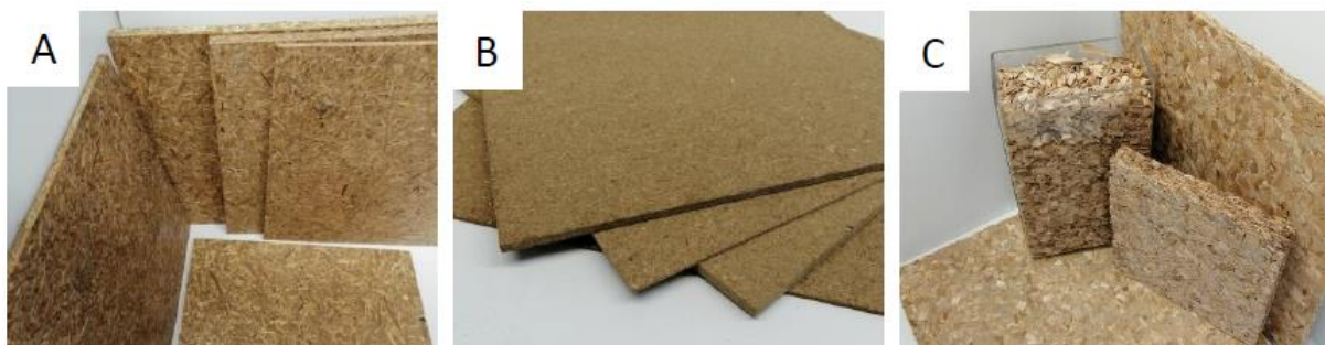
Abbildung 5-9 Plattenwerkstoffe aus Paludikulturen mit unterschiedlichen Aufbereitungsverfahren (A Heuplatten aus Seggen, Binsen, Schilf und Rohrglanzgras, B Faserwerkstoffplatten aus zerfasertem frischem Rohrglanzgras, Leichtbauplatte aus geschnittenen Typhastängeln)
