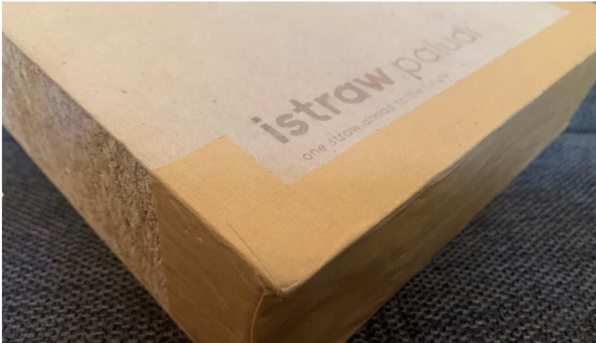
Abbildung 5-10 Die Paludi-Trockenbauplatte der Firma ISTRAW, (Foto: B. Spanjers)
