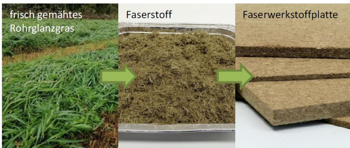
Abbildung 5-8 Grün geerntetes und frisch zu Faserstoff aufbereitetes Rohrglanzgras im Endprodukt einer Faserwerkstoffplatte (Abb. C. Lühr, in Spanjers 2021)
