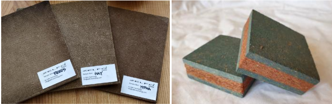
Abbildung 5-11 Faserverbundplatte aus Nasswiesen-Biomasse. Hergestellt von ZELFO Technology. (Foto: S. Manzel)
